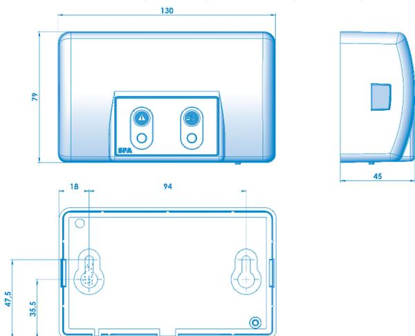
Для блока аварийной сигнализации **SANICOM®** не требуется отдельный источник питания. Питание подается устройством **SANICOM®**. В случае перебоев в подаче электроэнергии аккумулятор блока аварийной сигнализации принимает эту задачу на себя.
