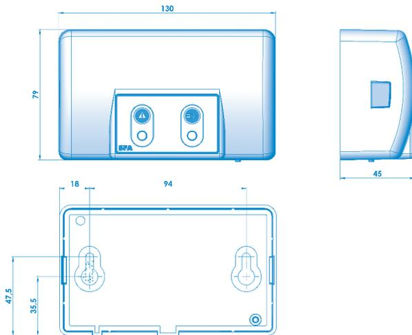
Le boîtier d'alarme du **SANICOM®** ne nécessite pas d'alimentation électrique indépendante. Cette alimentation se fait par l'intermédiaire du **SANICOM®**. En cas de coupure de courant, l'accu du boîtier d'alarme prend le relais.
