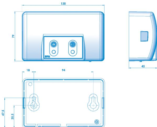
Moduł alarmowy przepompowni **SANICOM®** nie wymaga odrębnego zasilania. Zasilanie jest dostarczane przez urządzenie **SANICOM®**. W przypadku awarii zasilania, jego rolę przejmuje bateria modułu.
