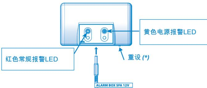
1/ 红色通用报警LED灯的工作原理与SANICOM®控制面板上的LED灯相同。报警单元在故障出现时即刻鸣响。按下面板上的重设(\*)键或报警单元下方按键可终止报警音。
