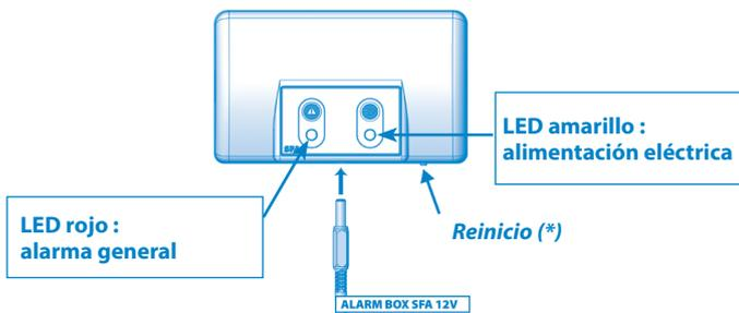
1 / El LED rojo de alarma general reproduce el funcionamiento del LED rojo en la tarjeta de base. La caja de alarma suena en caso de alarma mientras el defecto persista. Para que deje de sonar, pulse botón Reinicio (\*) del teclado del dispositivo o el botón situado bajo la caja de alarma.
