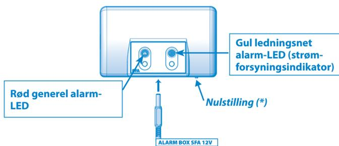
1/ Den røde generel alarm kontrollampe har forbindelse til den tilsvarende kontrollampe på **SANICOM®** kontrolpanel. Alarmenheden giver lyd, så længe fejlen er til stede. For at stoppe alarmløbet trykkes på nulstillingstasten (\*) på kontrolpanelet eller på tasten på alarmenheden.
