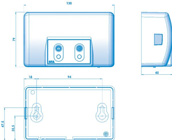
O Alarme remoto do **SANICOM®** não necessita de uma fonte de alimentação independente. A alimentação é fornecida pelo do **SANICOM®**. Em caso de falha eléctrica, a bateria do alarme remoto alarme liga-se.
