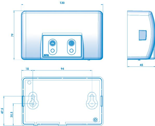
De **SANICOM®** -alarmunit vereist geen aparte stroomtoevoer. De stroom wordt geleverd via de **SANICOM®**. Bij een stroomuitval neemt de accu van de alarmunit het over.
