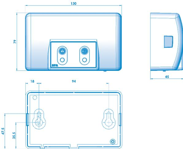
SANICOM® 报警单元无需独立电源供电。可通过 SANICOM®系统供电。停电时，报警单元的电池将供电工作。
