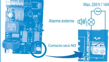
O conector do alarme pode ser ligado a um sistema de tensão. Este contacto é fechado desde que a estação está em modo alarme (exceto em caso de alarme setor) e mantém-se fechado enquanto a sirene de alarme toca.
