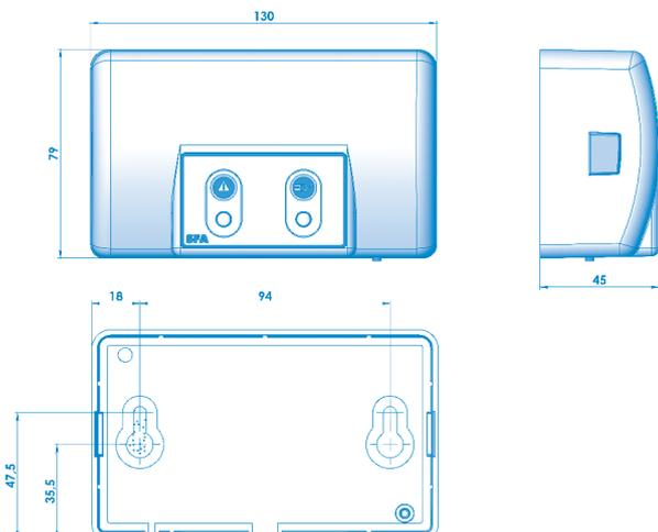
Unitatea pentru alarmă **SANICOM®** nu necesită o sursă de alimentare separată. Alimentarea electrică se face prin intermediul cartelei electronice a **SANICOM®**. În cazul unei căderi de tensiune, alimentarea electrică se face de la acumulatorul unității pentru alarmă.
