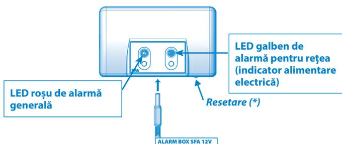
1/ LED-ul roșu pentru alarma generală reproduce funcționarea LED-ului corespunzător de pe panoul de comandă **SANICOM®**. Modulul mobil de alarmă produce un semnal sonor cât timp există defecțiunea. Pentru oprirea alarmei, apăsați butonul resetare (\*) de pe tastatura dispozitivului sau butonul de sub Modulul mobil de alarmă.
