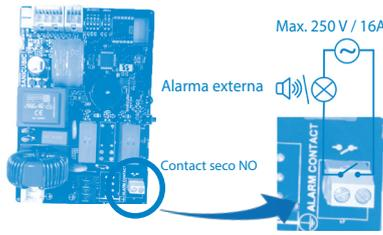
Posibilidad de externalizar la señal de alarma. Contacto seco (sin tensión) NO (normalmente abierto) accionado por un relé. El conector de la alarma podrá ser conectado a un sistema de energía. Este contacto se cierra cuando la instalación se pone en modo alarma (salvo alarma de corriente) y sigue cerrado mientras suena la sirena de alarma.
