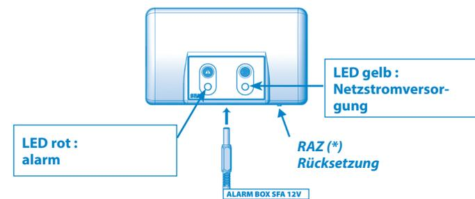
1/ Die Störmeldung am Gerät wird auf das Meldemodul übertragen die rote LED für Alarm leuchtet, ein akustisches Signal ertönt, so lange der Störbetrieb vorherrscht. Um das akustische Signal abzuschalten, drücken Sie den Resetknopf unten am Gehäuse des Melders (siehe Abb.)
