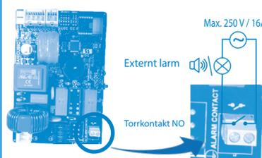
Larmsignalen kan utlokaliseras. Normalt öppen (NO) torrkontakt (ingen spänning) som aktiveras av ett relä.
