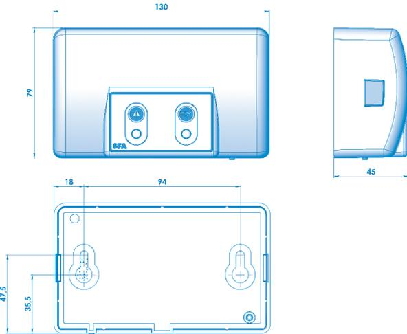
**SANICOM®**-larmet behöver inte någon separat strömförsörjning. Strömförsörjningen sker via **SANICOM®**. I händelse av strömavbrott tar larmenhetens batteri över.
