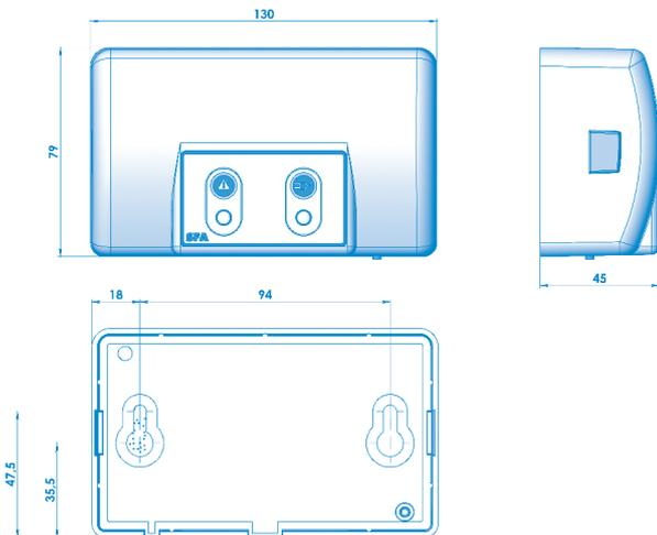
Per il montaggio a muro dell'unità, usare la seguente immagine come guida :
