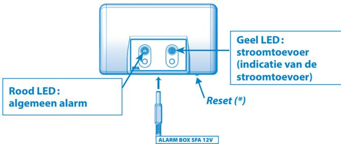
**Aansluiting van de alarmunit op het toestel:** Sluit de alarmkabel rechtstreeks aan op de unit.
