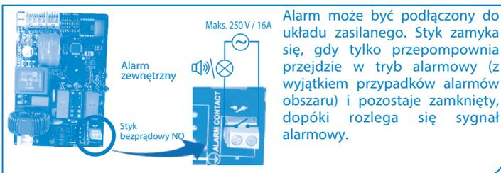
Alarm może być podłączony do układu zasilanego. Styk zamyka się, gdy tylko przepompownia przejdzie w tryb alarmowy (z wyjątkiem przypadków alarmów obszaru) i pozostaje zamknięty, dopóki rozlega się sygnał alarmowy.
