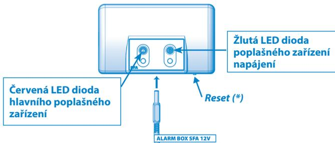
1/ Červená LED hlavního alarmu reprodukuje stav odpovídající LED diody na ovládacím panelu zařízení SANICUBIC®. Zvuková signalizace jednotky alarmu je aktivní po dobu přítomnosti závady. Pro zastavení alarmu stiskněte resetovací tlačítko na panelu stanice nebo tlačítko na spodní straně jednotky alarmu (\*).
