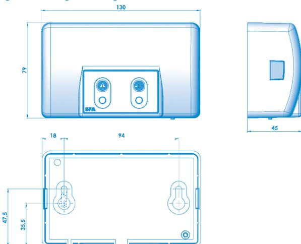
**SANICOM®** alarmenheden kræver ikke særskilt strømforsyning. Strømforsyningen sker via **SANICOM®**. I tilfælde af strømsvigt overtager alarmenhedens backup batteri.
