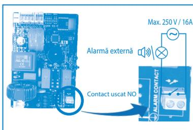
Contactul de alarmă poate fi conectat la un sistem alimentat.
