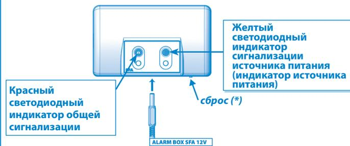
1/ Красный светодиодный индикатор общих аварийных сигналов повторяет работу соответствующего светодиодного индикатора на панели управления **SANICUBIC®**. Звуковой сигнал подается блоком аварийной сигнализации, пока неисправность не будет устранена. Для отключения аварийного сигнала нажмите кнопку сброса (\*) на панели устройства или кнопку внизу блока аварийной сигнализации.
