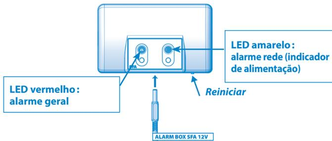
1/O LED vermelho do alarme geral reproduz a operação do LED correspondente no painel de controlo do aparelho. O som da unidade de alarme ouve-se enquanto a falha persistir. Para interromper o alarme, pressione o botão de reinício (\*) no teclado do aparelho ou o botão por baixo do alarme remoto.
