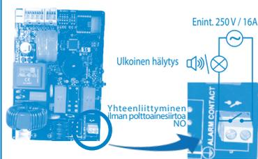
Tämä kontakti suljetaan, kun asema on hälytystilassa (aluehälytystä lukuun ottamatta), ja se pysyy suljettuna niin kauan kuin hälytysääni kuuluu.
