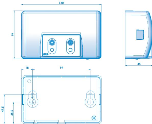
Jednotka alarmu **SANICOM®** nevyžaduje samostatné napájení. Je napájena prostřednictvím zařízení **SANICOM®**. V případě výpadku napájení je jednotka alarmu napájena baterií.
