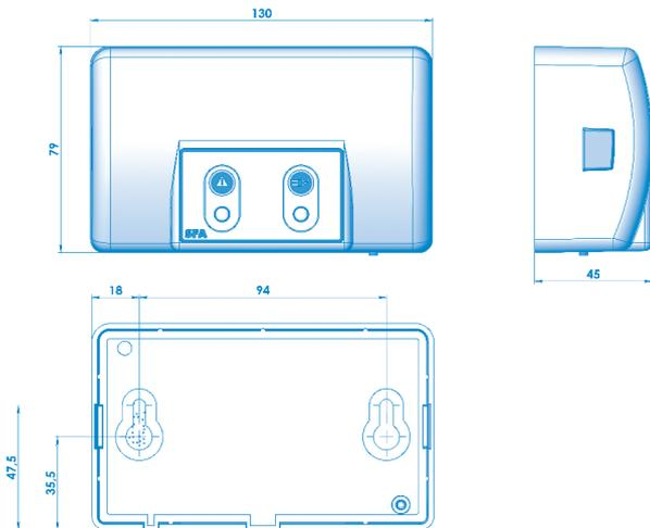
Der Kabelalarmmelder des **SANICOM®** braucht keine eigene Stromversorgung. Die Stromversorgung erfolgt über den **SANICOM®**. Bei Stromausfall übernimmt der Akku im Alarmmelder die Stromversorgung.
