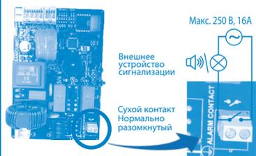
Сигнал тревоги можно передать на внешний подряд. Такие модели оснащены сухим (беспотенциальным) нормально разомкнутым контактом, которым можно управлять с помощью реле. Контакт сигнализации может быть подключен к системе, подключенной к источнику питания.
