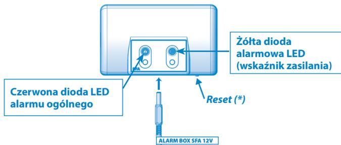
1/ Czerwona dioda LED alarmu ogólnego odzwierciedla działanie odpowiedniej diody LED na panelu sterowania przepompowni **SANICUBIC®**. Moduł alarmowy emituje dźwięk tak długo, jak długo występuje usterka. Aby wyłączyć, należy nacisnąć przycisk resetowania (\*) na klawiaturze urządzenia lub przycisk pod modułem alarmowym.
