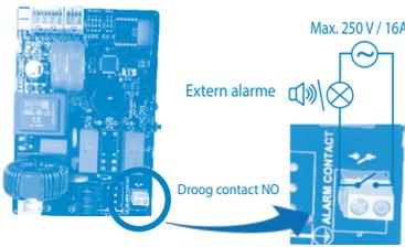
Mogelijkheid om het alarmsignaal extern te maken. Droogcontact (geen voltage) NO (normaal open) werkzaam bij maximaal 250V/16A relais.
