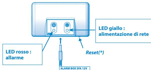
L'unità di allarme del **SANICOM®** non richiede un'alimentazione elettrica separata. L'alimentazione è fornita attraverso il **SANICOM®**. In caso di guasto dell'alimentazione, subentra la batteria dell'unità di allarme.
